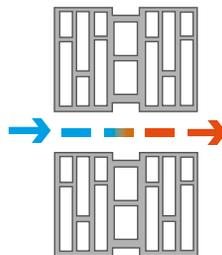
MAYOR NÚMERO DE CÁMARAS DE AIRE Y RUPTURA DEL PUENTE TÉRMICO EN LA JUNTA HORIZONTAL
